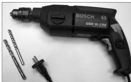
14.2. Taladro broca nº9 y 10.
